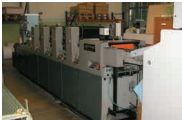
Die «Hafti»-Produktionsmaschine mit der Abrollung und den vier Druckwerken. Leimung und Endverarbeitung auf der Maschine bleiben ein Geheimnis.
